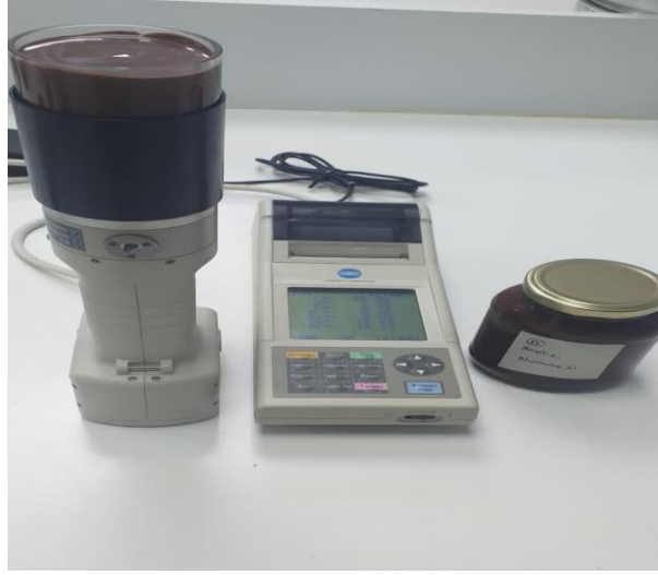
Şekil 3.3 CR-10 Minolta ile Renk Ölçüm İşlemi
