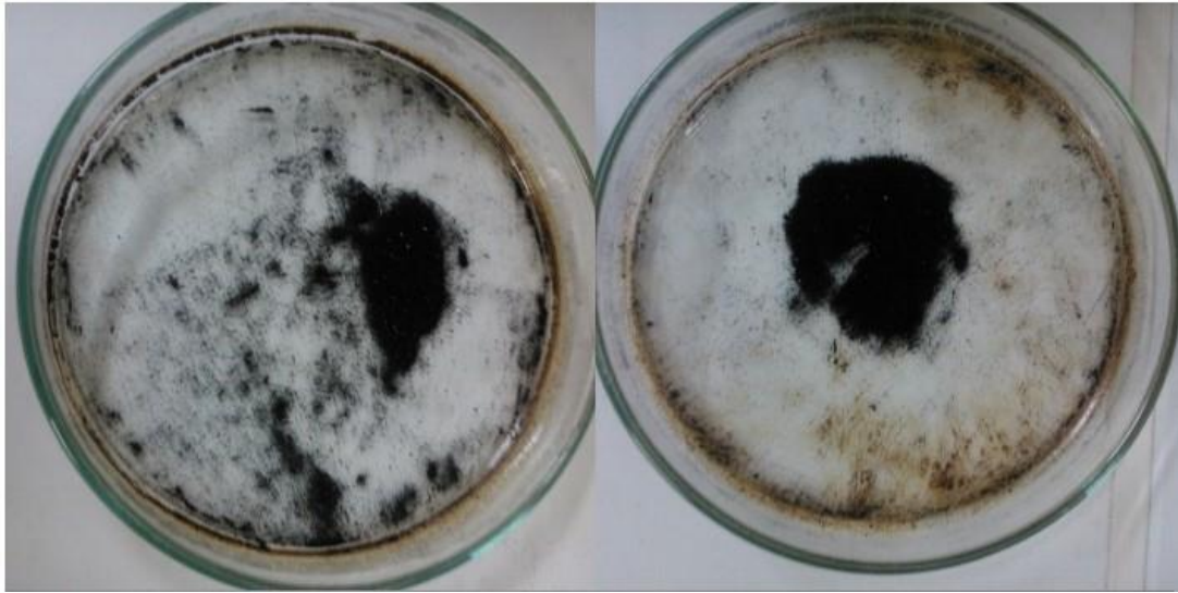
Şekil 4.1. Basit çöktürme yöntemiyle sentezlenen manyetik demir Oksit Nanopartikülleri
