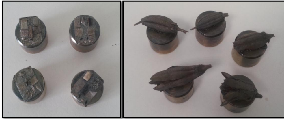
Şekil 3.2. SEM çekimine hazırlanan, sabitlenmiş altın kaplamalı numuneler
