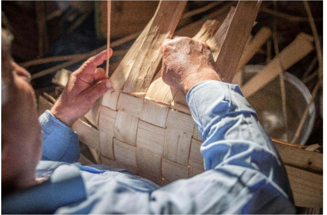
Görsel 52: Taban örme işlemi bittikten sonra gövdenin başlayacağı kısma ince fındık çubuklarından şerit geçirilir
