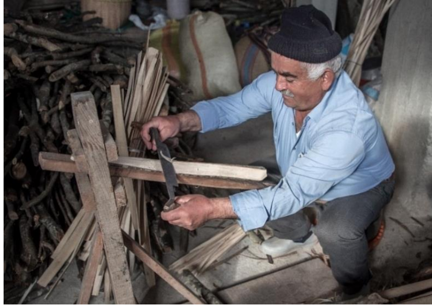
Görsel 47: Sepet yapımı için yontulmuş kestane ağacı dalları
