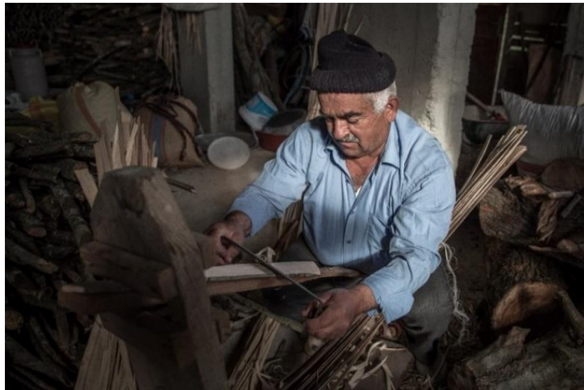
Görsel 48: Düzeltme tezgâhında inceltme işlemi yapılmakta
