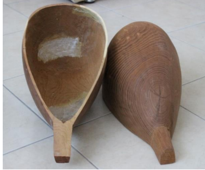
Görsel 14: Oyularak oluşturulmuş tekne kısmı
