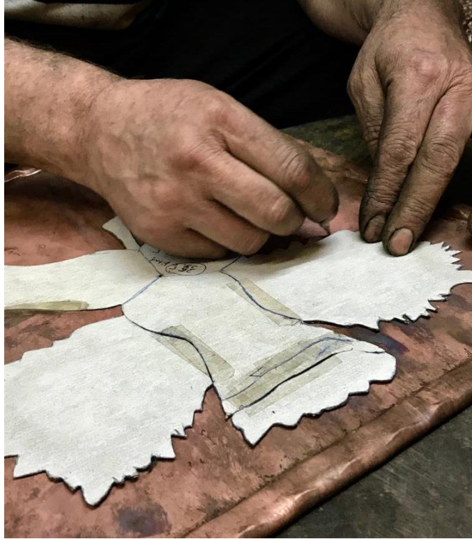
Görsel 85: Bakır levha üzerine istenilen şeklin çizimi yapılır
