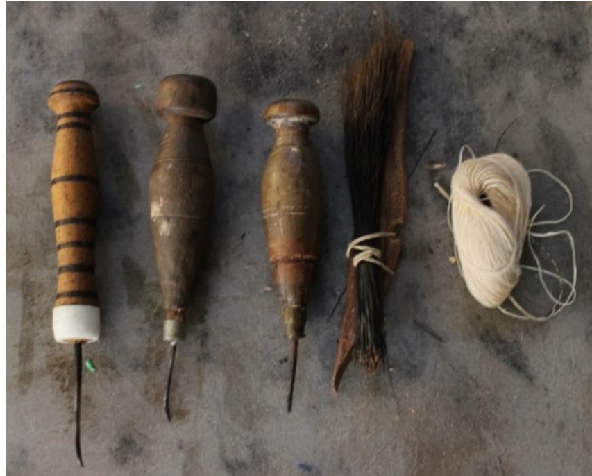
Görsel 156: Deri üzerinde delik açmaya yarayan tığlar, iğne olarak kullanılan domuz kılı ve ip
