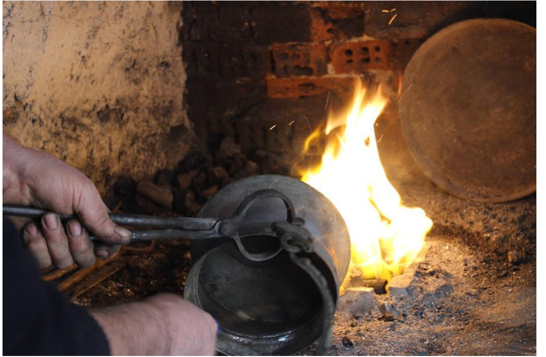
Görsel 103: Kısaçla tutulan bakırca kalaylama yapılmakta
