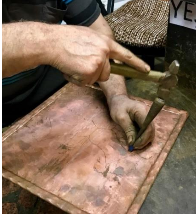
Görsel 86: Çizimi tamamlanan şekil çekiç ve çivi yardımıyla belirginleştirilir
