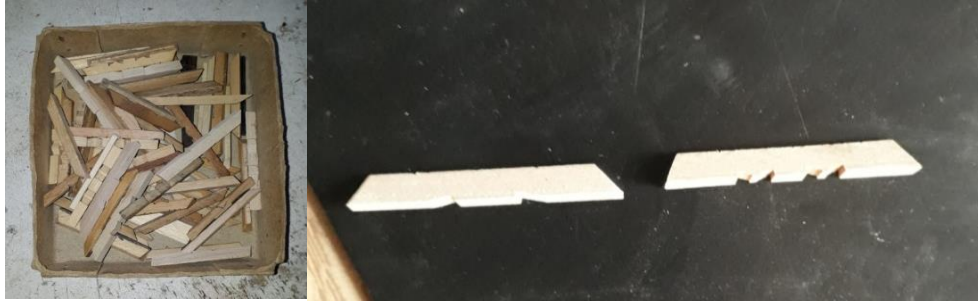
Görsel 22: Şimşir ve meşe ağacından yapılmış orta ve üst eşikler
