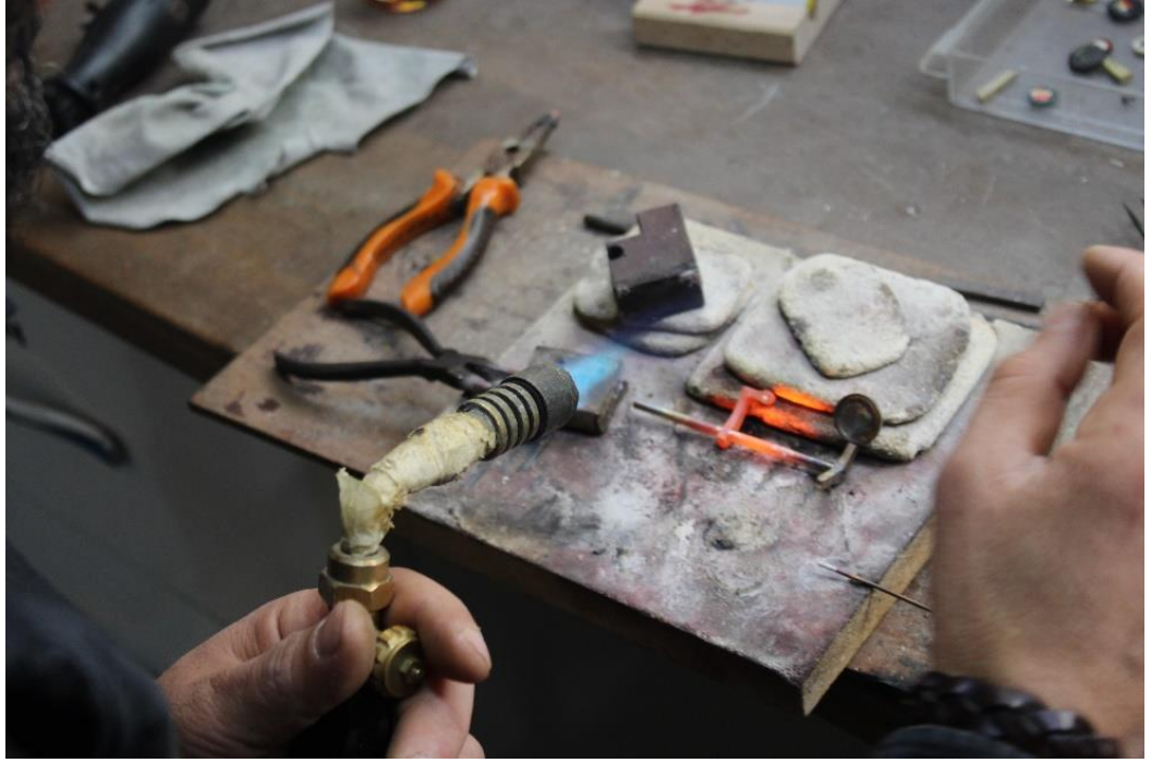
Görsel 66: Klarnetin metal aksamının kaynakla birleştirme işlemi
