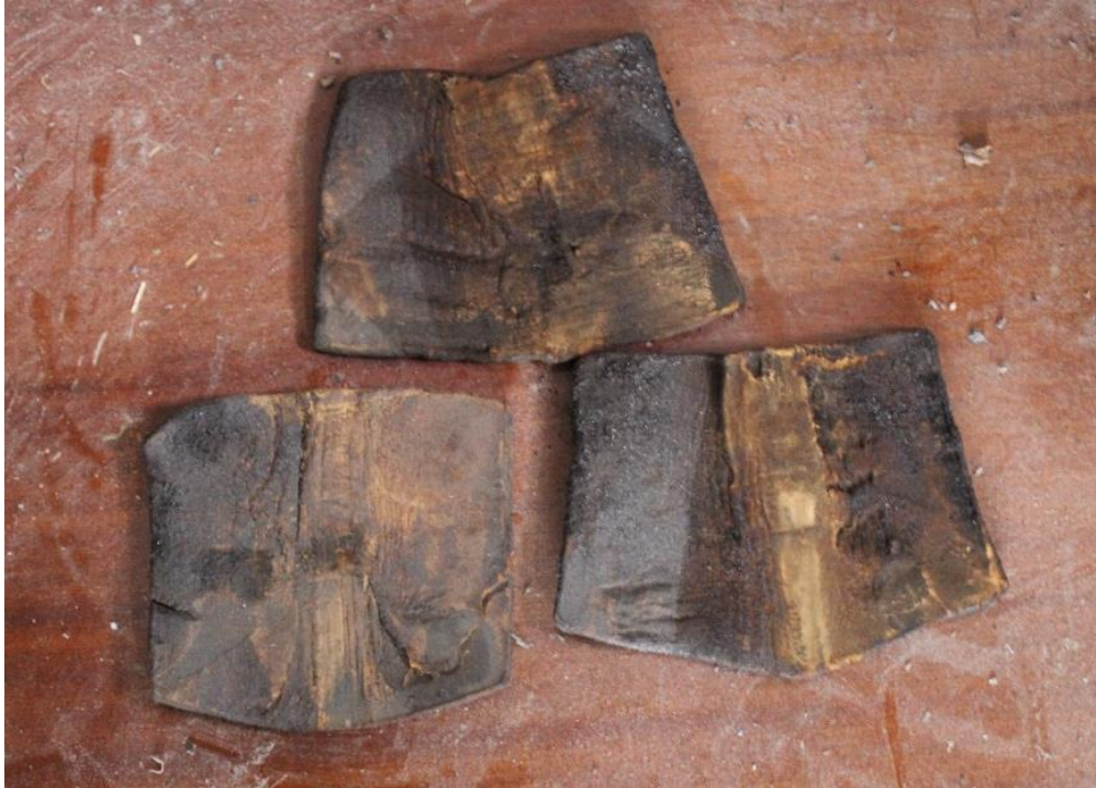
Görsel 144: Ateşte ısıtılarak preste düzleştirilen sığır boynuzları
