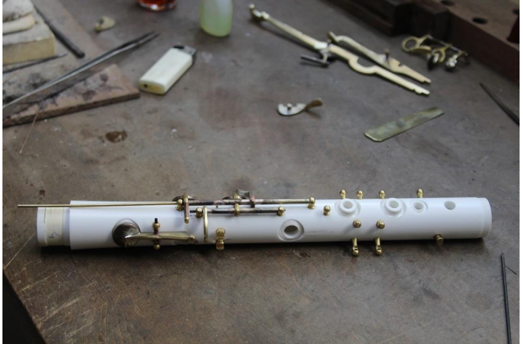
Görsel 67: Gövde kısmına yapılan metal aksamın montajı
