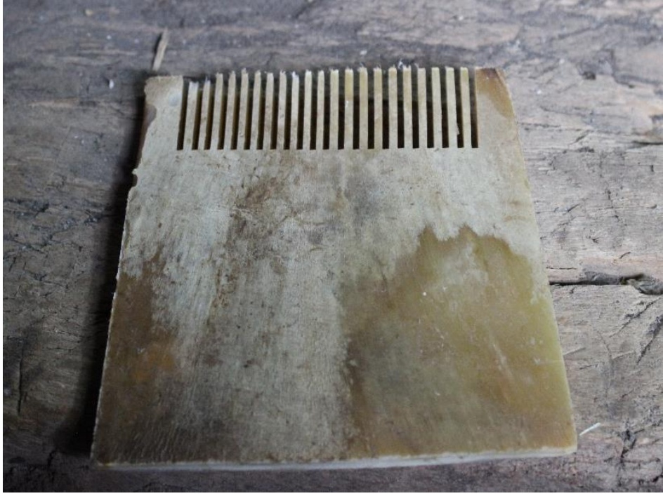
Görsel 147: Tarağın tek tarafına seyrek dişler açılmış hali
