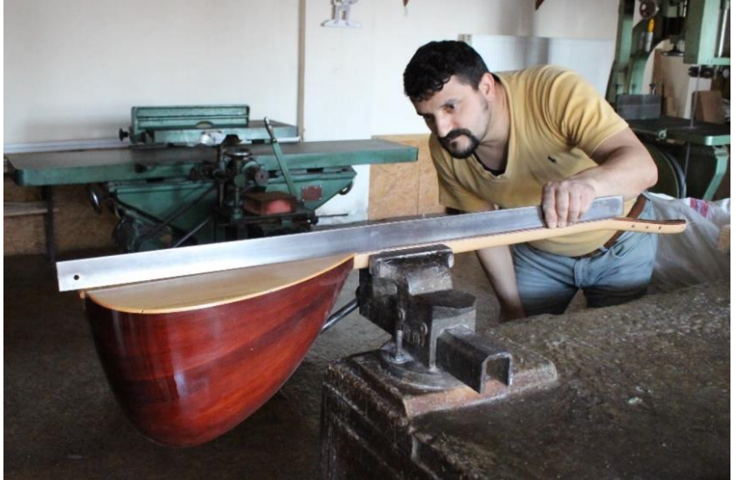
Görsel 20: Sap ve burguluğun ölçümlerinin yapılması
