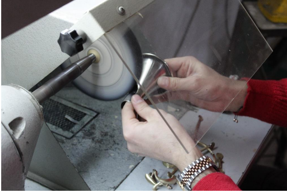
Görsel 68: Alüminyumdan yapılmış kalak kısmına parlatma işlemi yapılmakta
