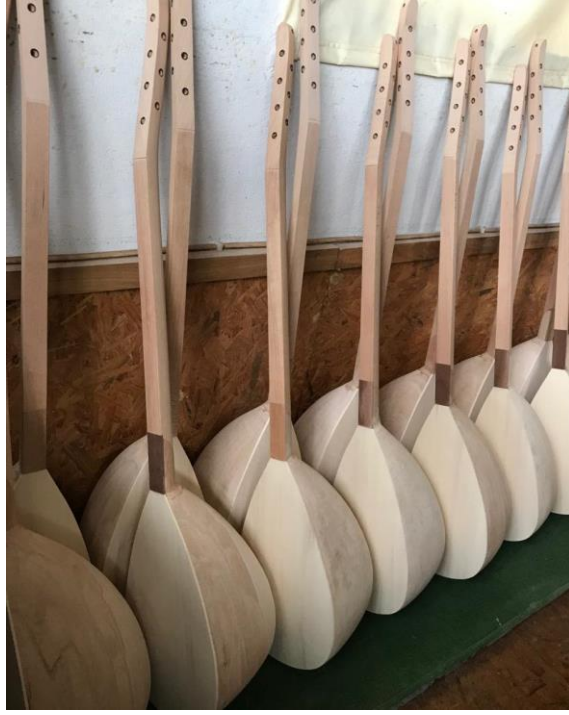
Görsel 21: Tekne sap ve burguluk montajı sonrası
