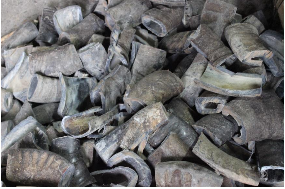
Görsel 143: Kesilen boynuzlara ateşte açılma işlemi yapılmadan önce
