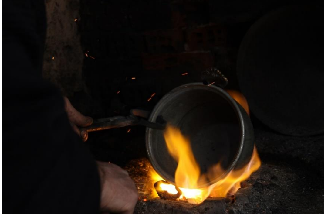
Görsel 102: Bakır tencerenin kalaylama öncesi ateşte ısıtılması
