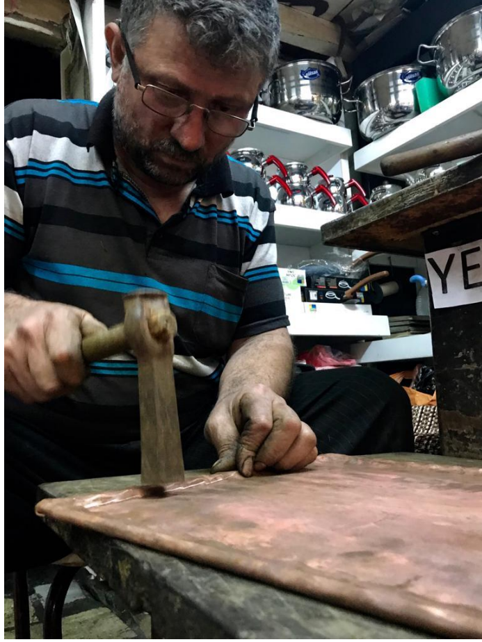
Görsel 84: Örs ve çekiç yardımıyla darbeleme yöntemi uygulanmakta
