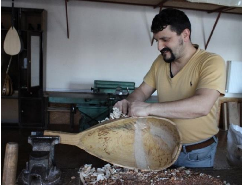
Görsel 13: Tekne kısmına dış formun verilmesi
