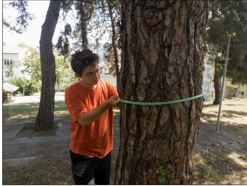
Şekil 3.17 Ağaçların Göğüs Yüksekliğindeki Gövde Çevresinin Ölçülmesi
