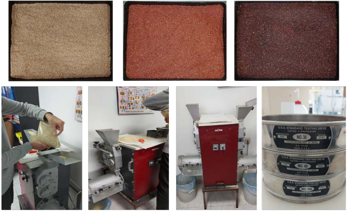
Şekil 3.2 Kinoa Tohumları ve Öğütme/Eleme Sistemleri
