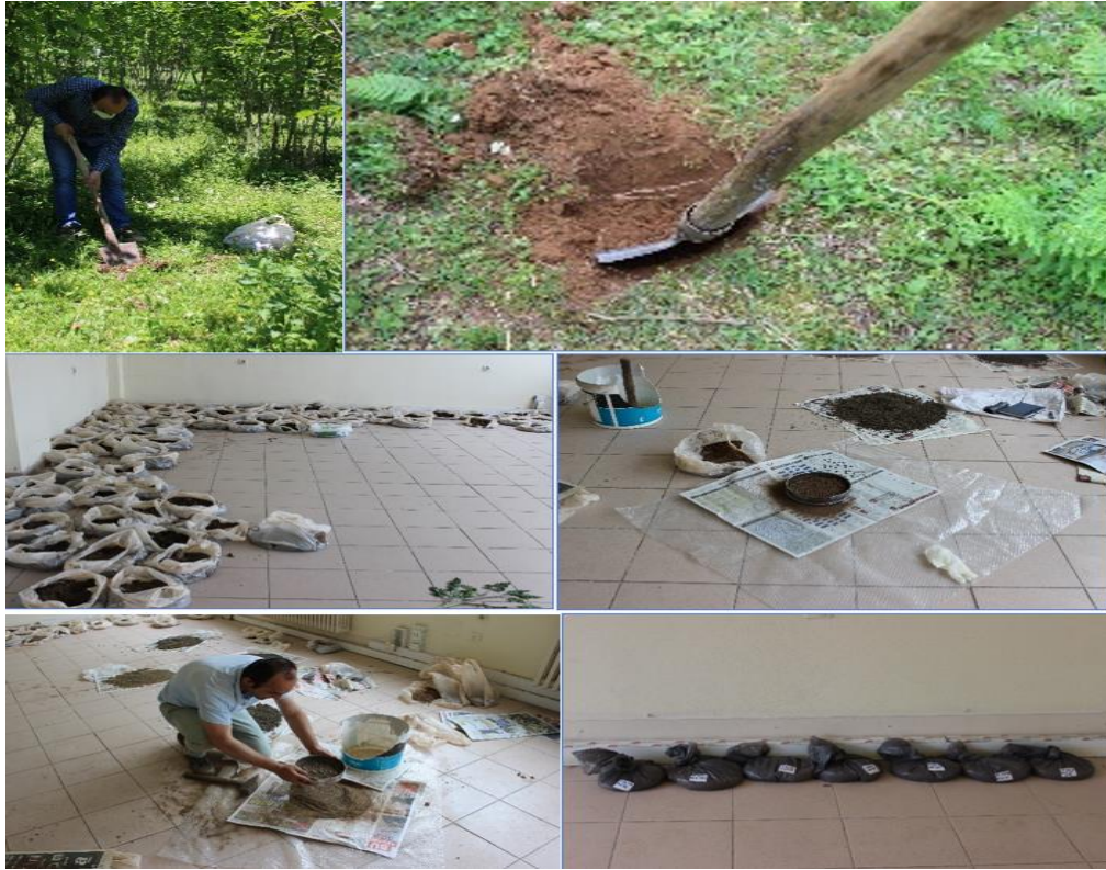
Şekil 3.5 Toprak Örneklerin Alınması, Kurutulması ve Eleme İşlemleri
