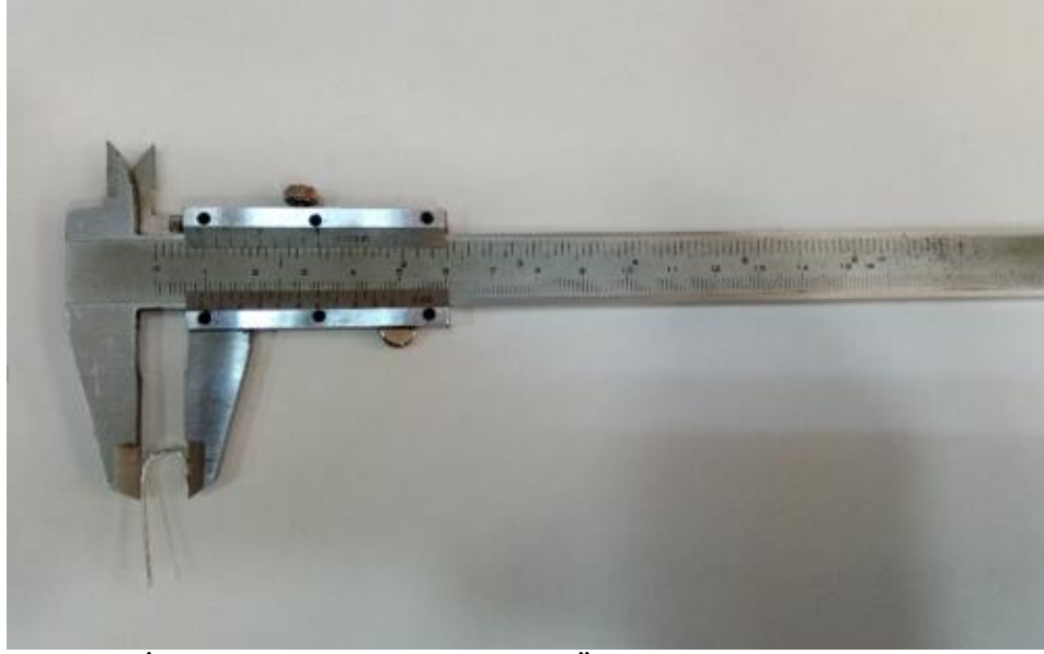
Şekil 3.3 İğnelerin Kumpas Yardımıyla Ölçülmesi (Orjinal)
