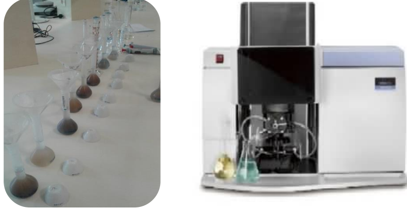
Şekil 3.13 Yaş Yakma Çalışması ve AAS Cihazı
