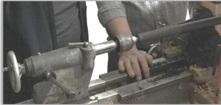
Resim 73. Ağacın silindir şeklini alana kadar metal tornada işlem görmesi
