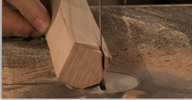
Resim 72. 4 x 4 cm ağacın köşelerinin kesilmesi 159
