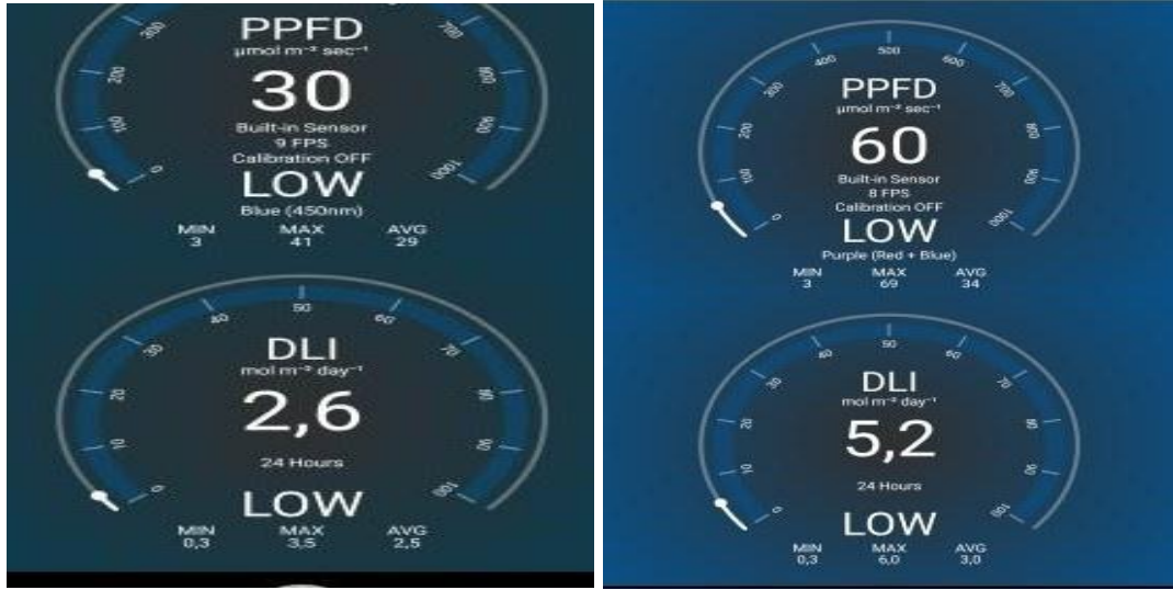
Şekil 3.4 Mavi/Kırmızı LED (30/30 \mu\text{mol}/\text{m}^2/\text{s} (Mor: 60 \mu\text{mol}/\text{m}^2/\text{s} ) PPFD Meter ile Ölçümü
