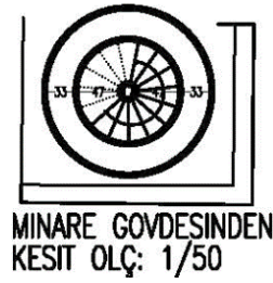
Çizim 13. Minare Gövde Kesiti (Tokat VBM Arşivi)
