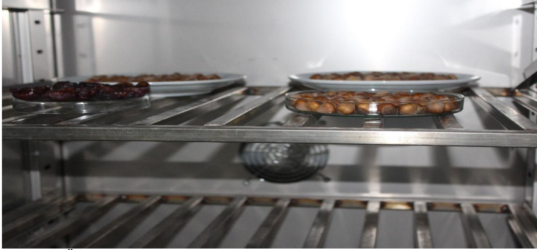
Şekil 3.8 Üç Farklı Boyuttaki Fındıkların Etüv’de Kurutulması
