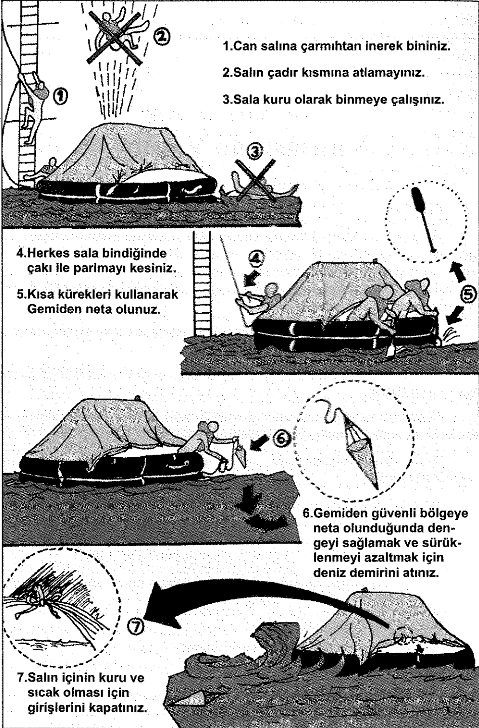
Şekil 7.1 Gemiyi terkten sonra can salında yapılacak işlemler.
