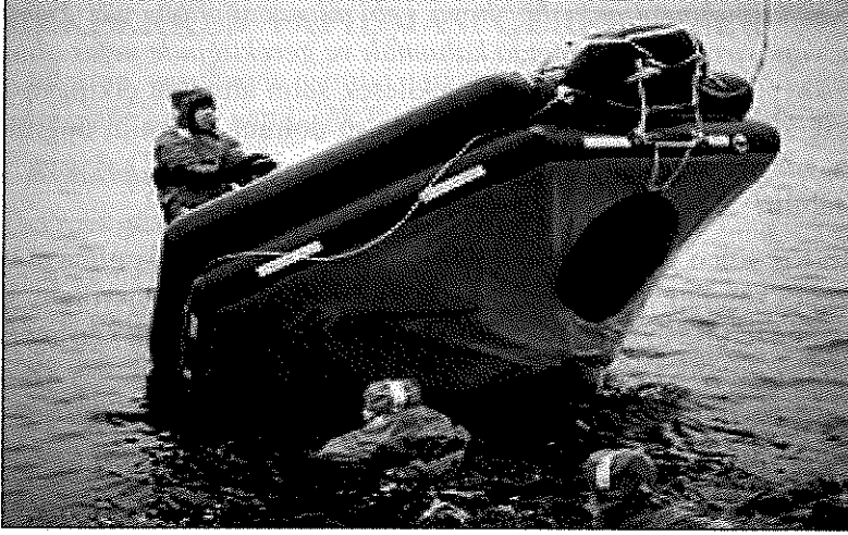
Şekil 7.15 Ters dönmüş can salının doğrultulması.
