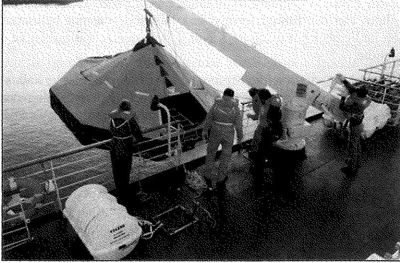
Şekil 2.10 Mataforada şişirilen can salı role talimi.
