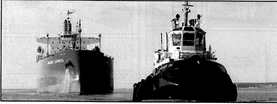
Şekil 12.16 Römorkör tarafından manevradan aciz geminin çekilmesi.
