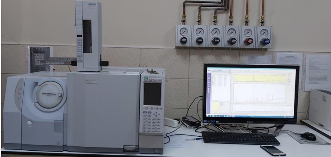
Şekil 3.5 GC-2010 Plus Gaz Kromatografi Sistemi
