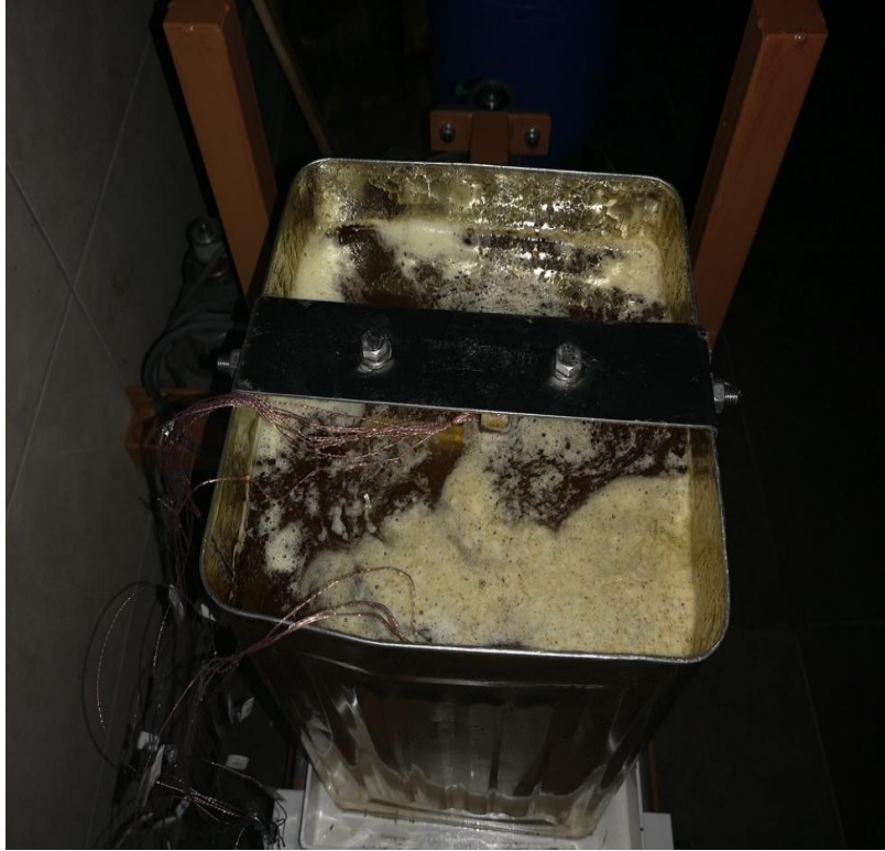
Şekil 3.9 Geleneksel Yöntemle Havalı Kuru Fırın İçerisinde Sıvılaştırmış Bal
