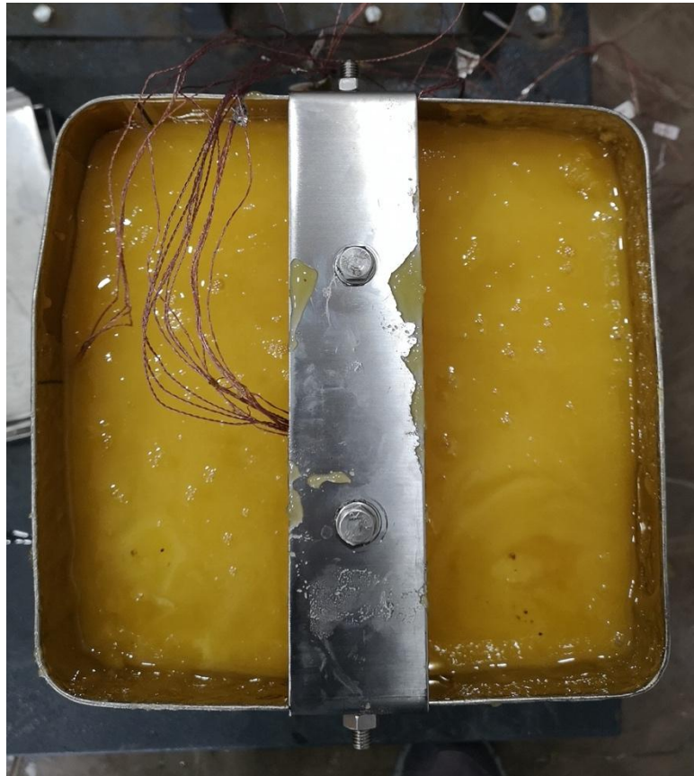
Şekil 3.11 Titreştirici Mekanizma ile Sıvılaştırılacak Olan Kristalize Bal
