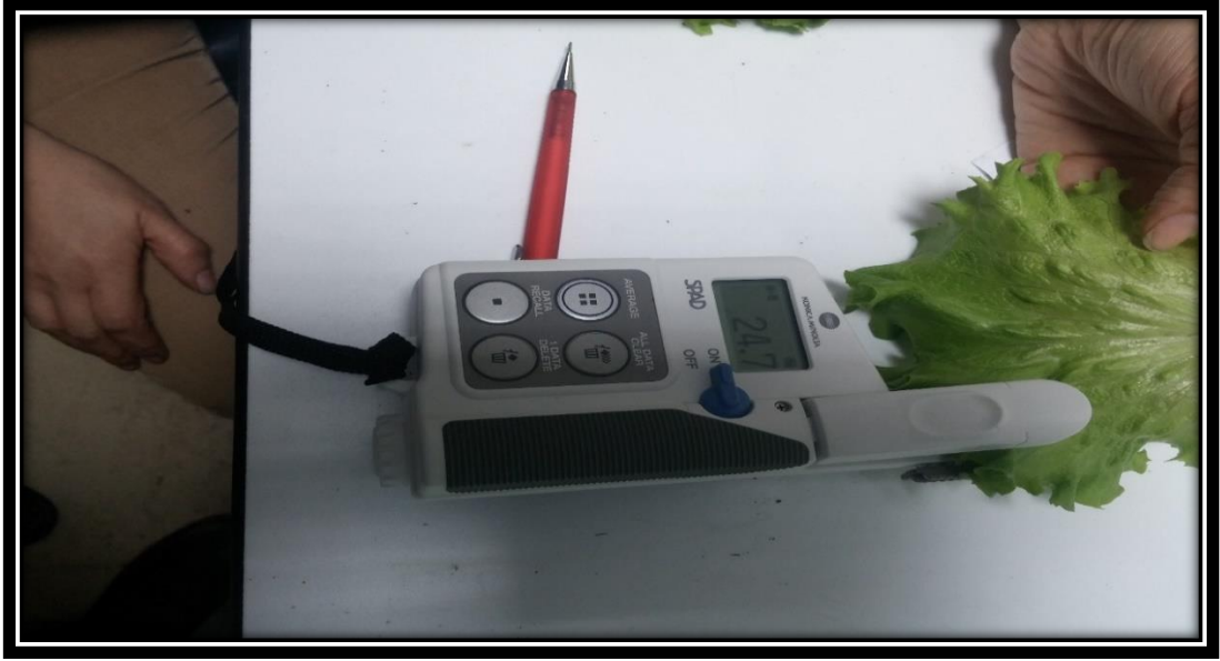
Şekil 3.10. SPAD değeri ölçümü
