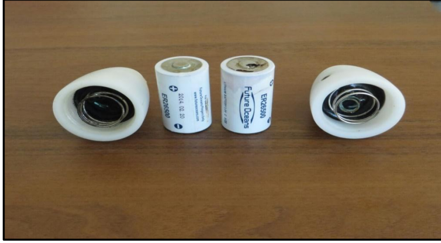
Şekil 5.1 Deneme sırasında arızalanmış pingerler ve piller
