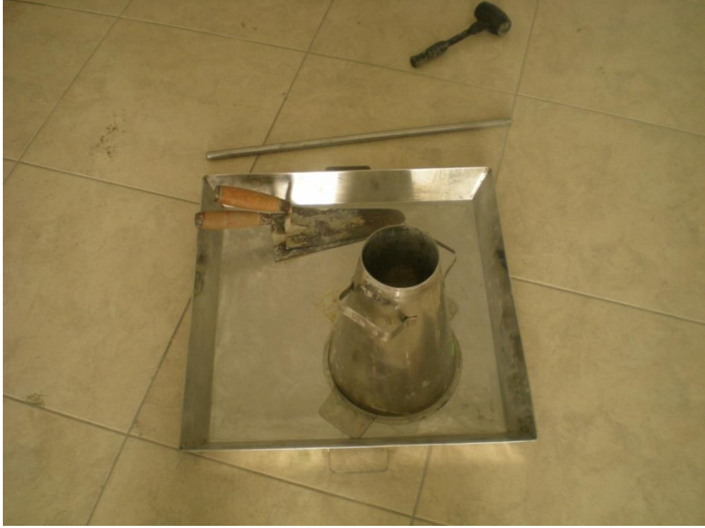
Şekil 3.21. Taze betonun işlenebilirliğinin tespitinde kullanılan Slump deney seti
