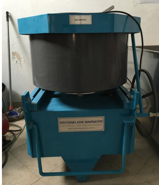
Şekil 3.17. Düşey eksenli (Pan tipi) betoniyer
