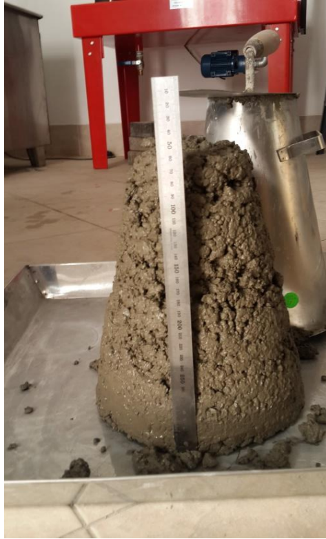
Şekil 4.21. Taze betonun Slump deneyi
