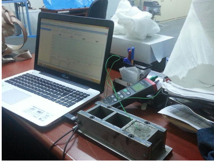
Şekil 3.8. Çimento harç numunelerinin datalogger ile sıcaklık ölçümleri
