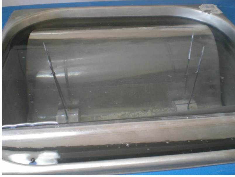
Şekil 4.11. Hacim genleşme deneyi anından bir görünüm
