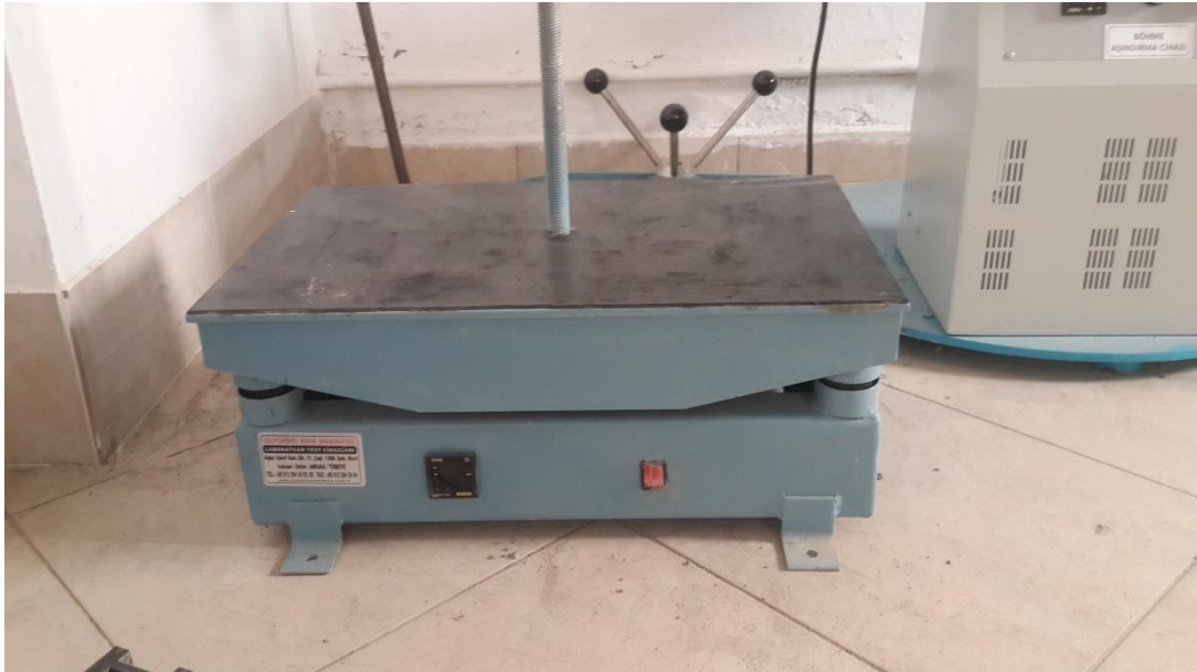
Şekil 3.19. Numunelerin yerleştirilmesinde kullanılan sarsma tablası
