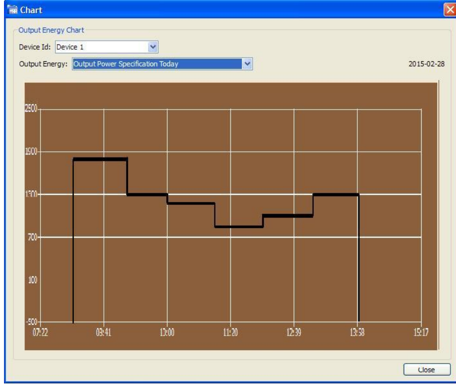
Şekil 4.24. Rüzgâr türbini saatlik enerji üretim miktarları
