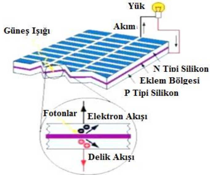
Şekil 3.2. Güneş paneli kesiti
