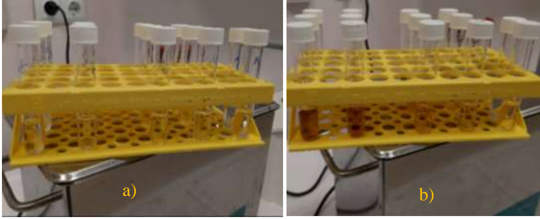
Şekil 4.9 Vanilin-sülfirik asit yöntemi ile toplam saponin tayini a) Reaksiyonun hazırlanması b) Reaksiyonun ısıl inkübasyon sonrası renk değişimi
