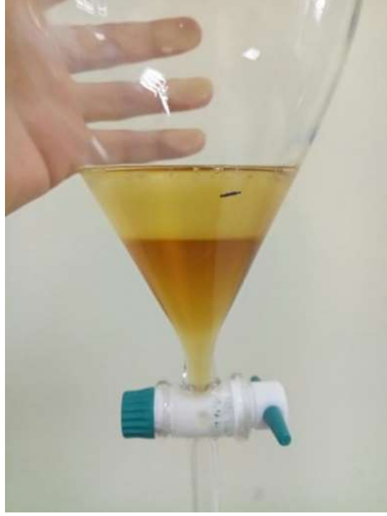
Şekil 3.6 Çöven ekstraktının saflaştırılması
