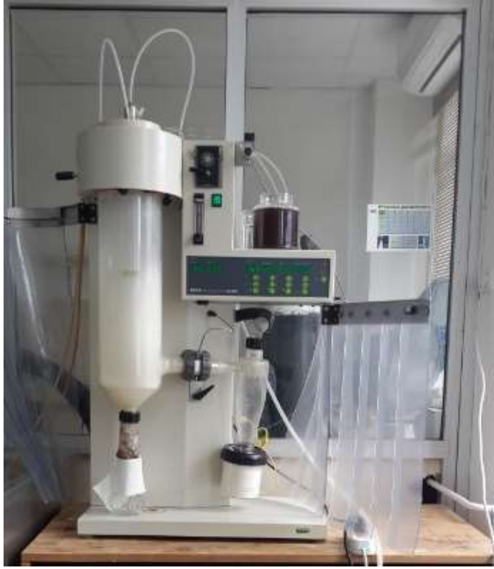
Şekil 3.3 Çöven ekstraktının püskürtmeli kurutucu ile toza dönüştürülmesi
