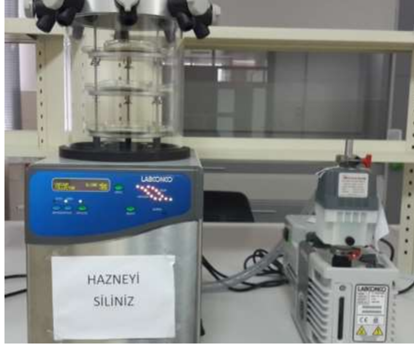
Şekil 3.4 Çöven ekstraktının liyofilizatör ile toza dönüştürülmesi
