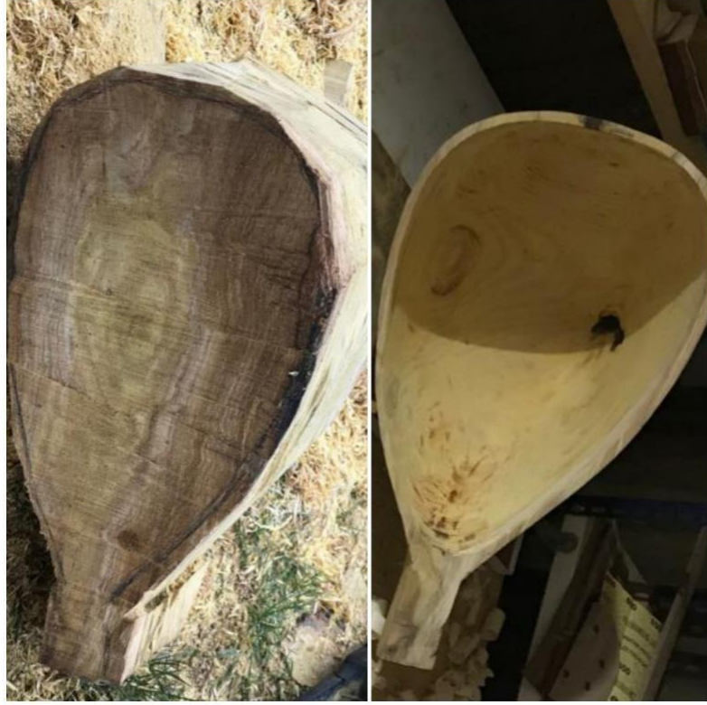
Görsel 17: Dut Tekne, Oyma Öncesi ve Sonrası.
