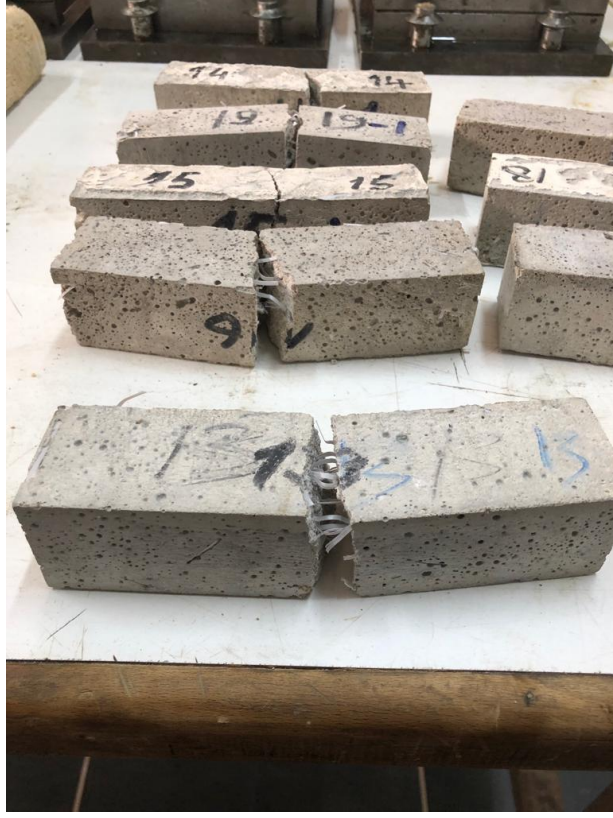
Şekil 4.13 Kırılmış numunelere ait kısmi görünüm
