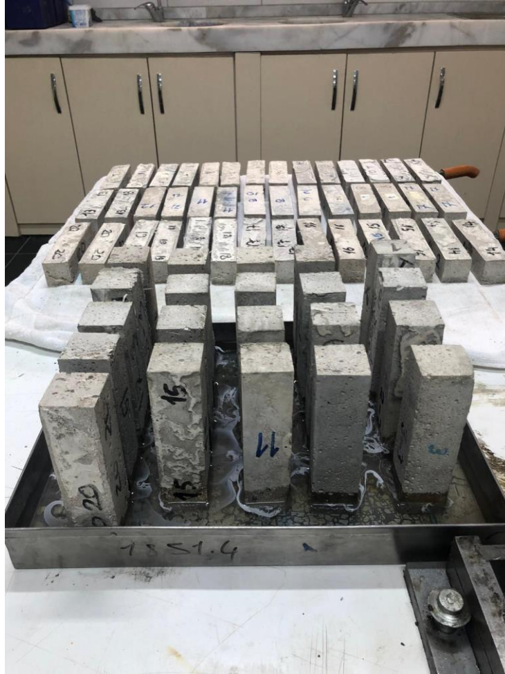
Şekil 3.13 Kılcal su emme deneyine ait bir görünüm
