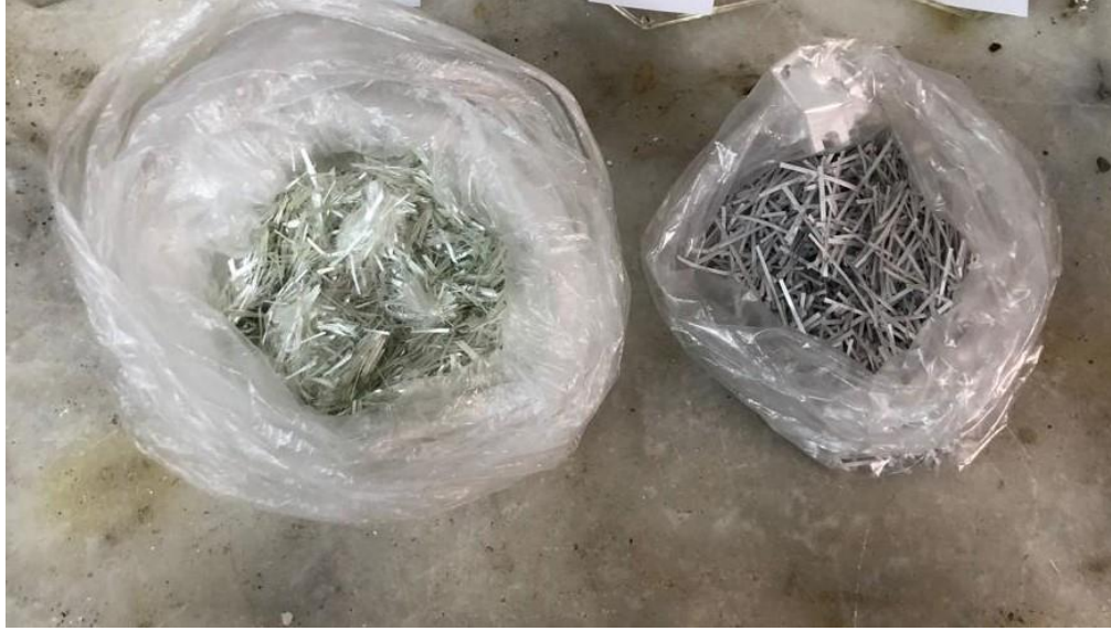
Şekil 3.3 Numunelerde kullanılan sırasıyla mikrosentetik ve makrosentetik lifler
