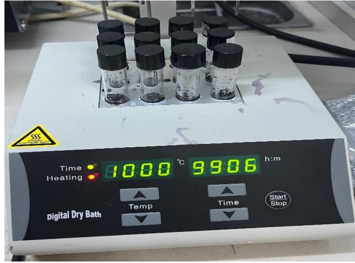
Şekil 3.9 Kayısı örneklerinin 100 °C' de 180 dakika hidroliz aşaması
