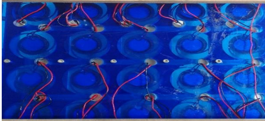
Şekil 3.9 Enerji Hasatçı Bağlantıları
