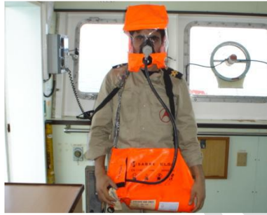
Resim 1.23: EEBD (Emergency escape breathing device) giyilmesi
