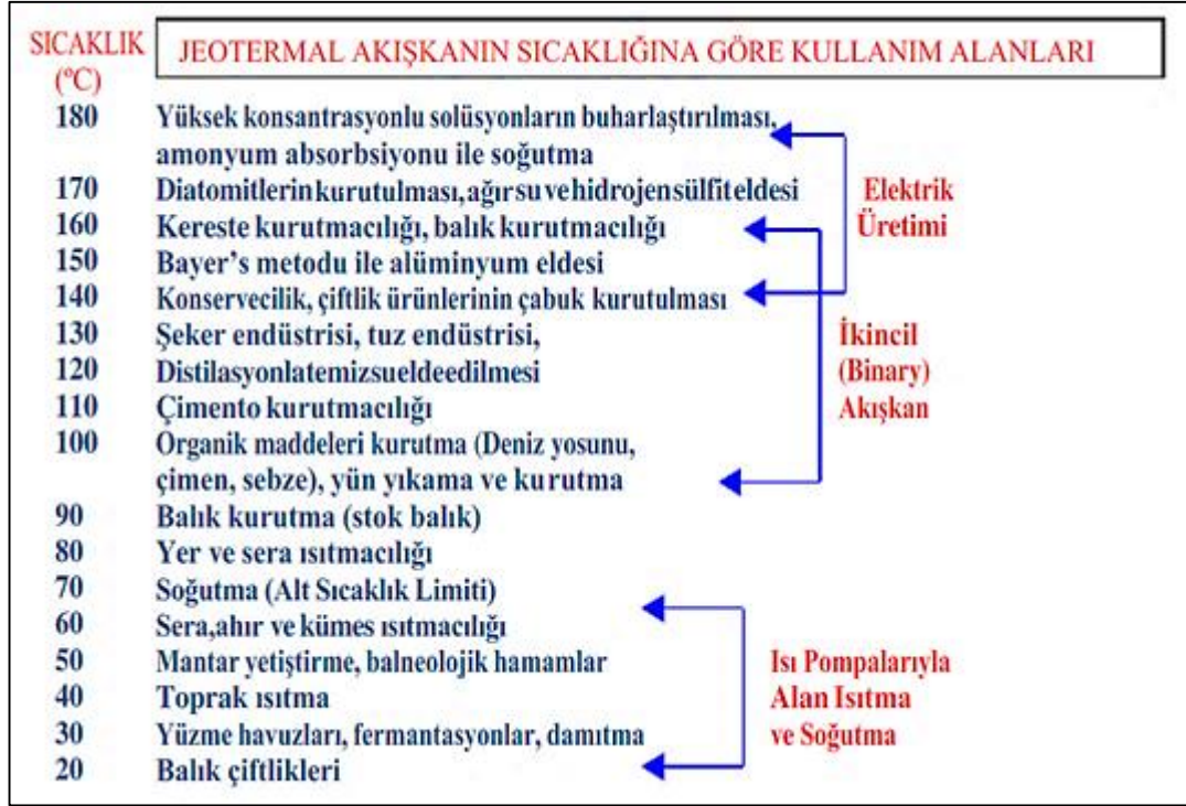
Şekil 3.4 Jeotermal Akışkanın Sıcaklığına Göre Kullanım Alanları (Lindal, 1973)
