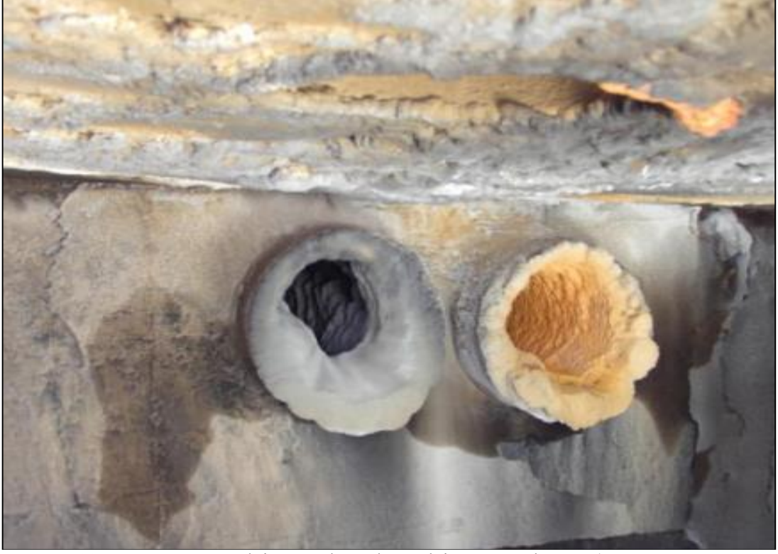
Şekil 3.13 Jeotermal Sondaj Kuyularında Kalsiyum Karbonat ( \text{CaCO}_3 ) Kabuklaşması (Düzağaç, 2015)
