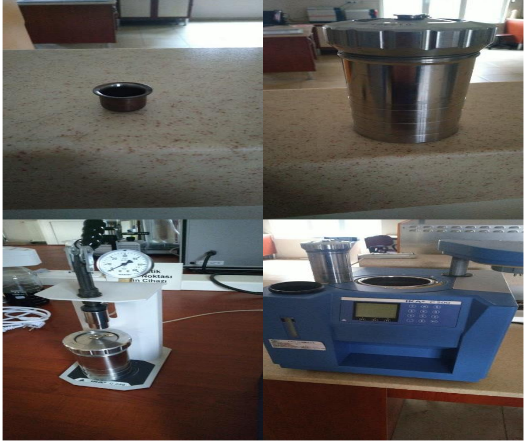
Şekil 3.10 Kalorimetre cihazı ile alt ısıl değerlerin tespiti.
