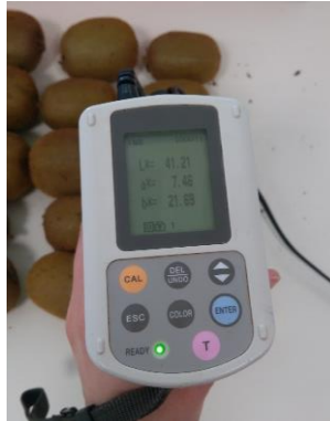
Şekil 3.4. Meyve Kabuk Rengi Ölçümü Ölçümüne Ait Görüntü
