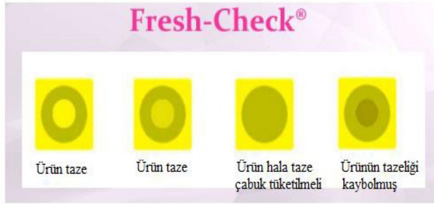
Şekil 2.5 Fresh-Check Polimer Bazlı Zaman-Sıcaklık İndikatörleri (Anonim, 2011)
