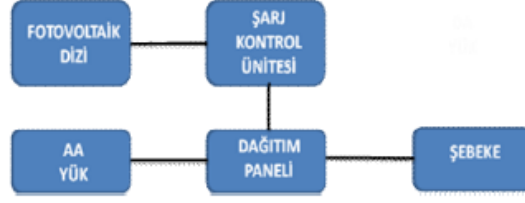
Şekil 3.6 Şebeke bağlantılı (on-grid) PV sistem tasarımı
