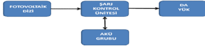
Şekil 3.4 Şarj kontrollü akülü PV sistem tasarımı
