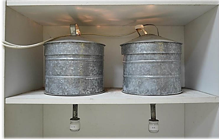
Şekil 3.23. Akar ekstraksiyonunda kullanılan berlese hunisi
