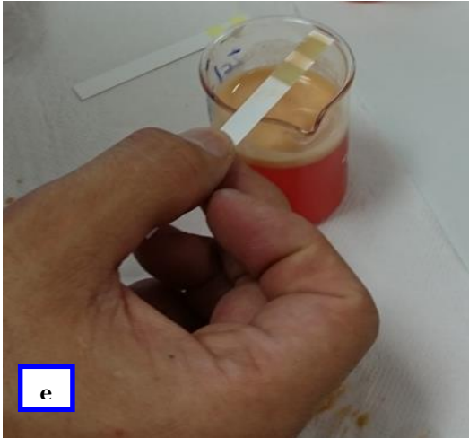
Şekil 3.7. Meyve eti sertliği (a), renk (b), SÇKM (c), titre edilebilir asitlik (d) ve C vitamini ölçümü (e, f).
