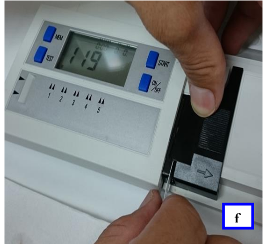
Şekil 3.7. Meyve eti sertliği (a), renk (b), SÇKM (c), titre edilebilir asitlik (d) ve C vitamini ölçümü (e, f).
