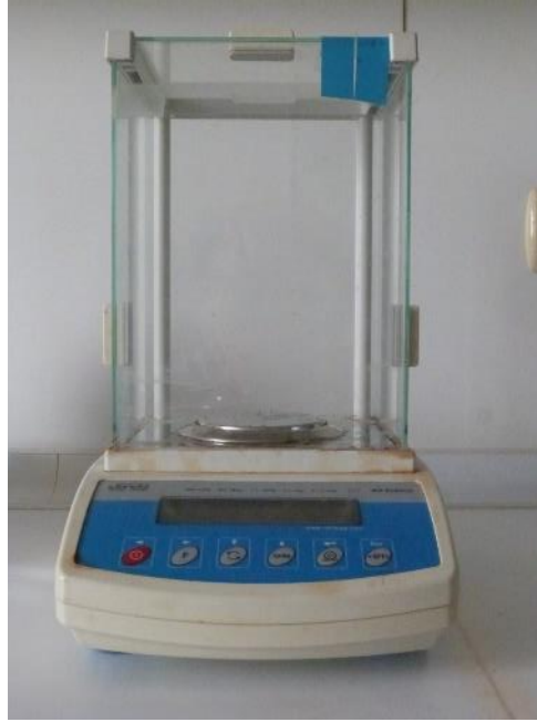
Şekil 3.2 Dokuların Tartılması İçin Kullanılan Hassas Terazi (Radwag AS 220/C/2)
