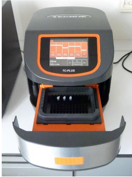
Şekil 3.5 PZR Yükseltgemeleri İçin Kullanılan Thermal Cycler (Techne TC-PLUS)
