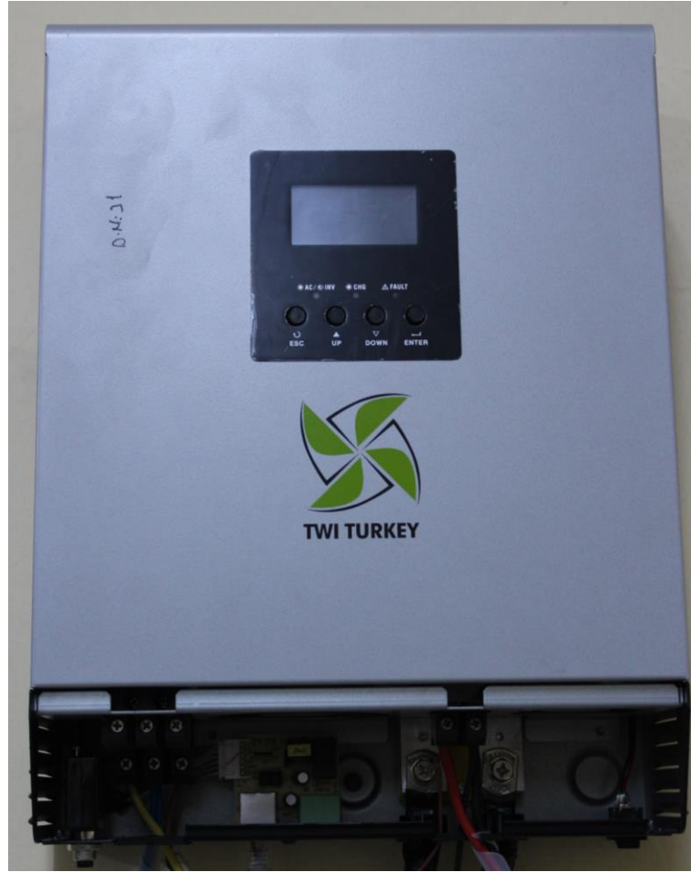
Şekil 3.3. Tam sinüs inverter
