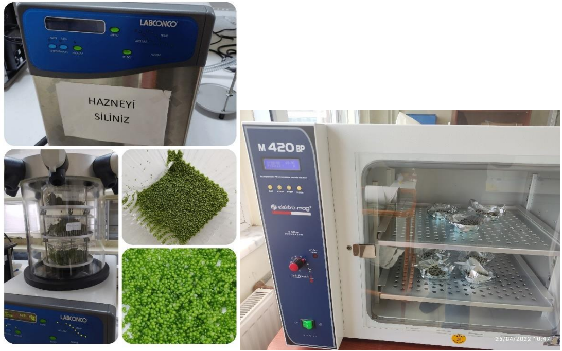
Şekil 3.4 W. arrhiza 'nın Liyofilizatörde (Solda) ve Etüvde (Sağda) Kurutma İşlemleri
