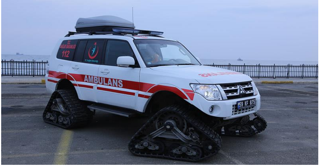
Şekil 2. 5.Özel Donanımlı Paletli Kar Ambulansı (Sağlık Bakanlığı, 2022)
