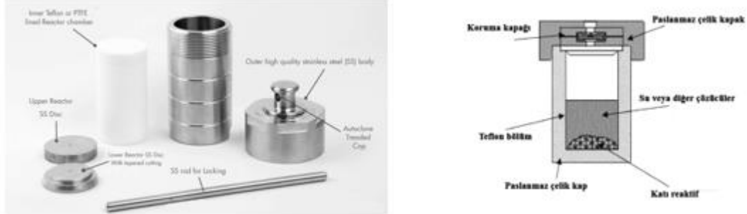
Şekil 1.3 Hidrotermal reaksiyon kabı (otoklav) şeması (Kamacı ve ark., 2019).
