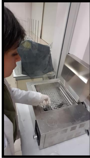
Şekil 3.8 İndirgen Şeker Analizinde 100°C Su Banyosu Aşaması
