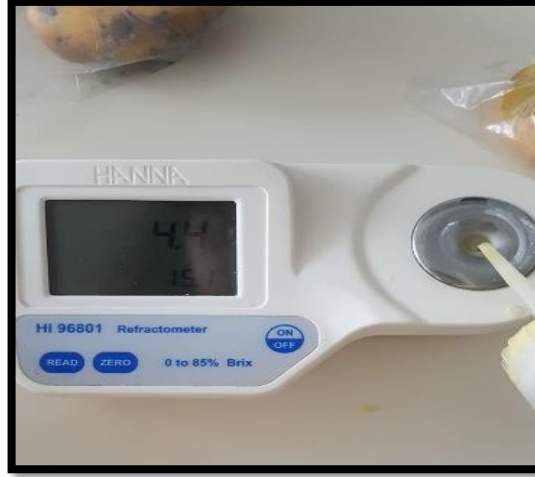
Şekil 3.10 El refraktometresi ile Suda Çözünür Kuru Madde Miktarı Ölçümü
