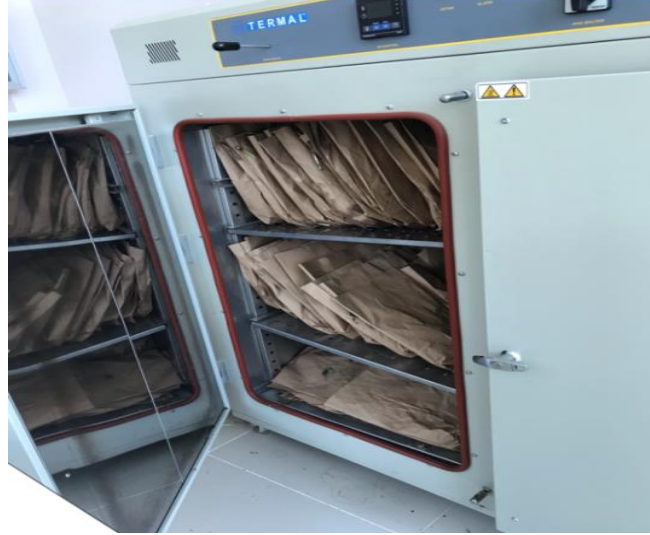
Şekil 3.14 Deneme Alanından Hasat Edilen Bitki Örneklerinin Kurutma Makinesi ile Kurutma İşlemi
