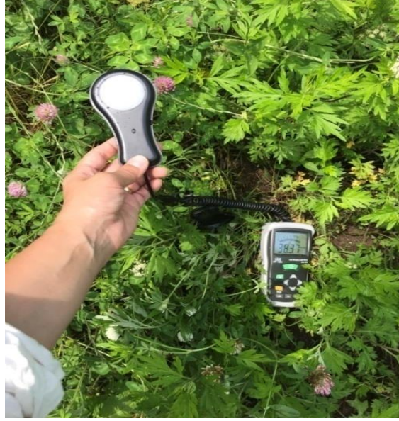
Şekil 3.10 Lüksmetre ile Gölgeleme Oranının Belirlenmesi
