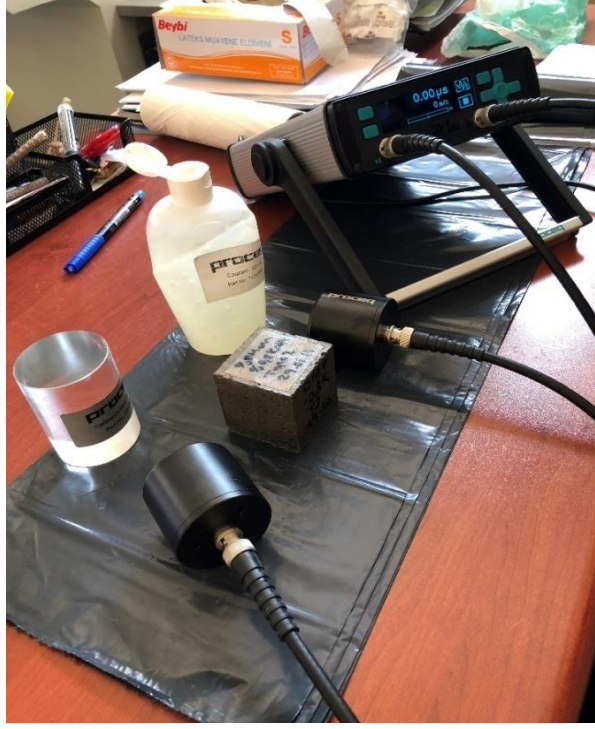
Şekil 3.15 Ultrases geçiş hızı ölçümü
