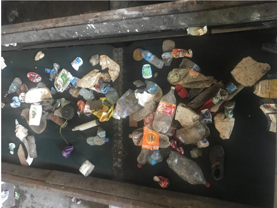
Şekil 7.1 Balistik Ayırıcının Üç Boyutlu Hattından Çıkan Malzeme Örneği
