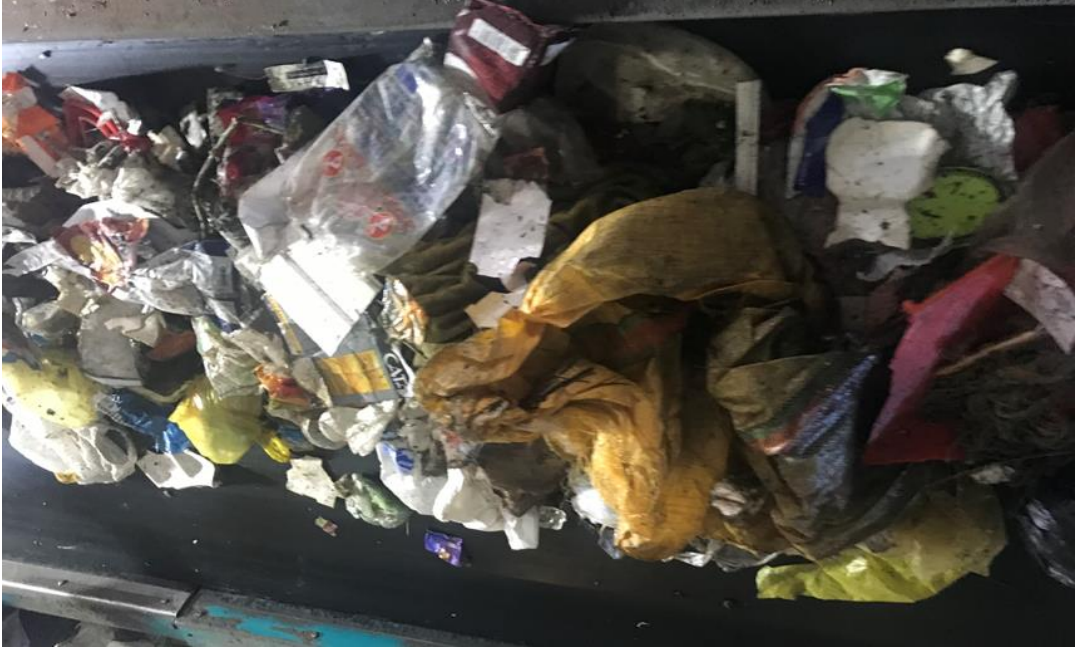
Şekil 7.2 Balistik Ayırıcının İki Boyutlu Hattından Çıkan Malzeme Örneği
