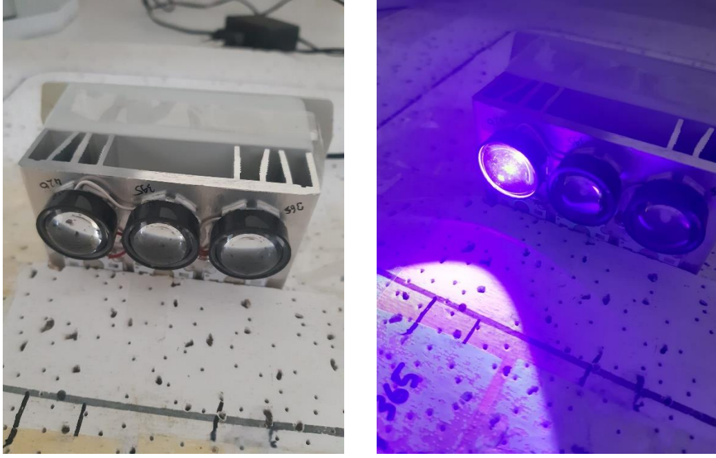
Şekil 4.6 CO Salınımı İçin Kullanılan UV Lamba Düzeneği
