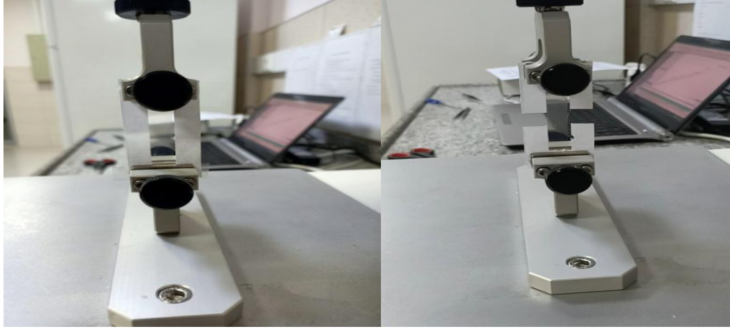
Şekil 3.6 Yardımcı Kağıt-Bant ile Filmlerin Cihazdaki Görüntüsü
