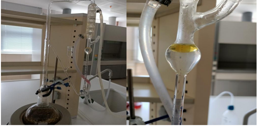
Şekil 3.1 Sudan Hafif Clevenger Destilasyon Düzenegi ve Uçucu Yağ Eldesi Görseli
