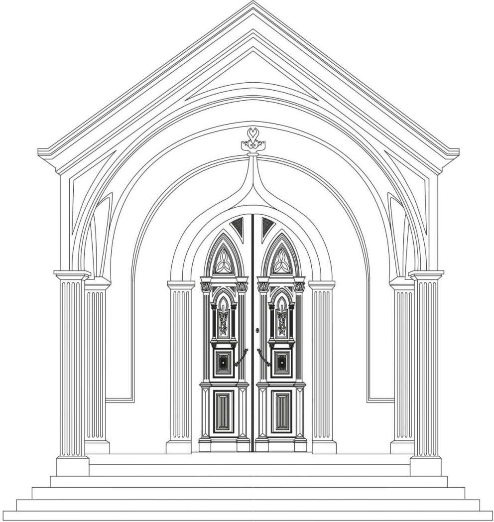
Şekil 18. Giresun Eski Katolik Kilisesi Kuzey Cephe Sundurma Ögesi (Çizim: Semanur Sarimahmutoğlu)
