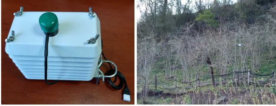
Şekil 3.5 Sıcaklık, Nem ve PAR Veri Kaydedici Cihaz ve Bahçedeki Görünümü
