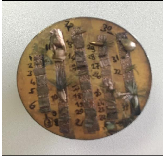
Şekil 3.10 SEM Çekimine Hazırlanan, Sabitlenmiş Altın Kaplamalı Numuneler
