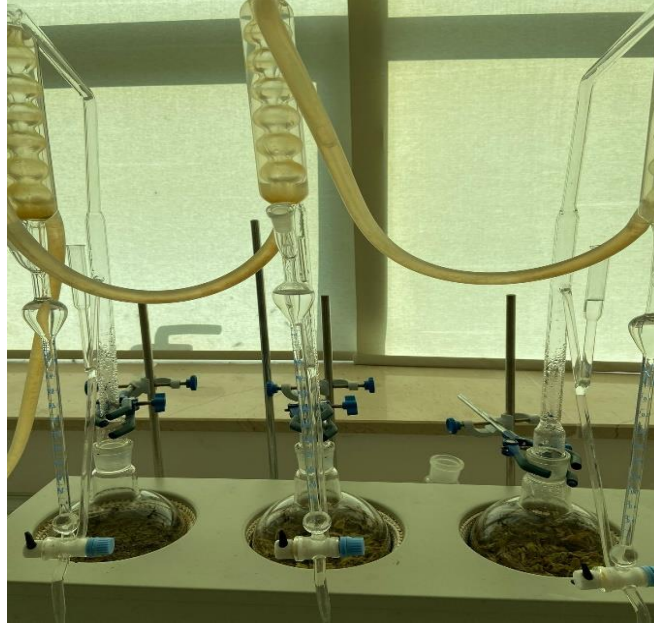
Şekil 3.9 Clevenger cihazı ile uçucu yağ analizi
