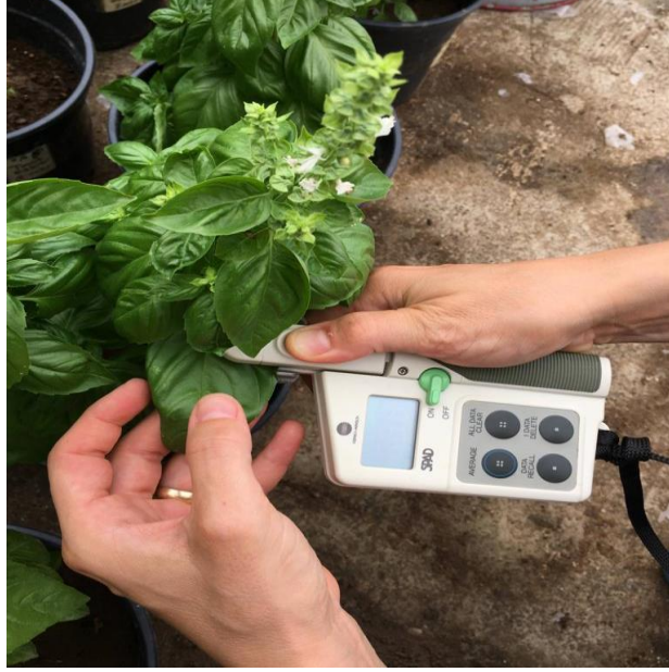
Şekil 3.13 Klorofilmetre cihazıyla klorofil ölçümü
