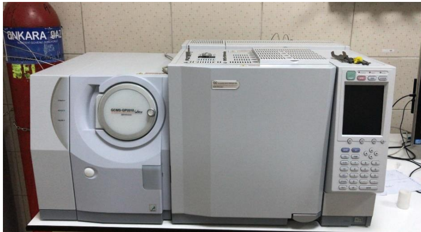
Şekil 3.10 Uçucu Bileşen Analizinde Kullanılan GC-MS Cihazı
