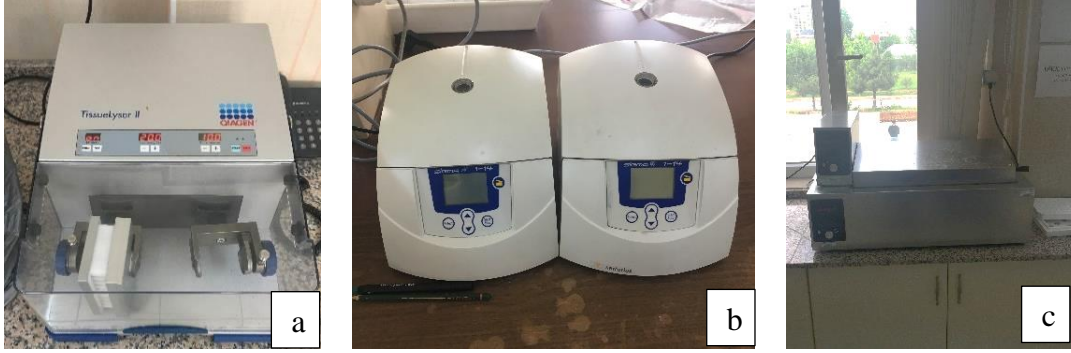
Şekil 3.11 DNA izalasyon aşamasında kullanılan cihazlar [dokü parçalayıcı (a), santrifüj (b) ve sıcak su banyosu (c)]
