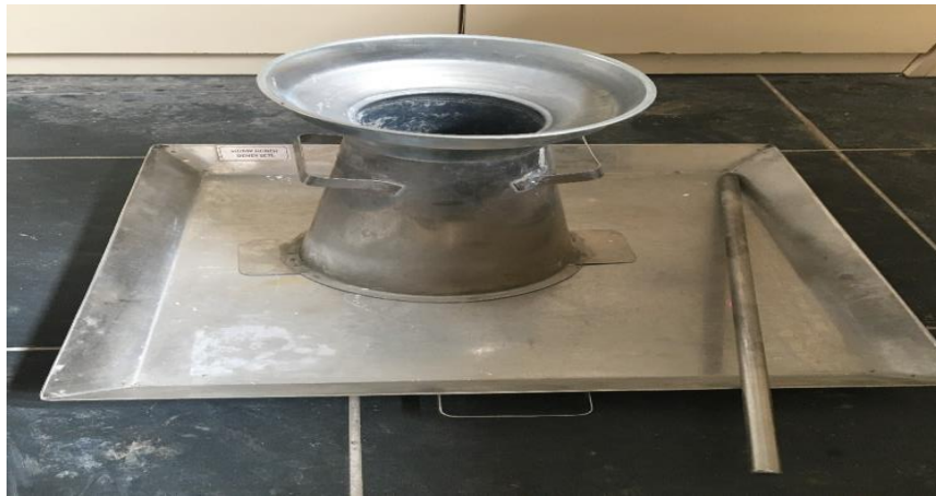
Şekil 4.9 Taze Betonun İşlenebilirliğinin Tespitinde Kullanılan Slump Deney Seti
