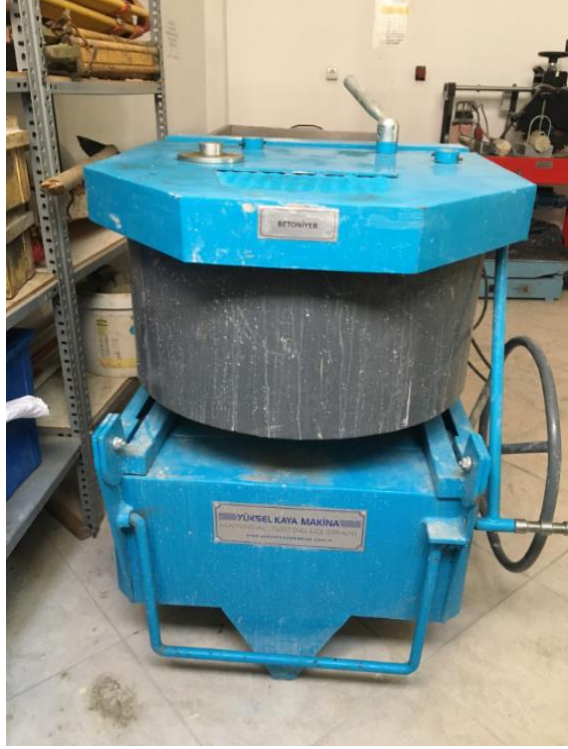
Şekil 4.5 Düşey Eksenli (Pan tipi) Betoniyer
