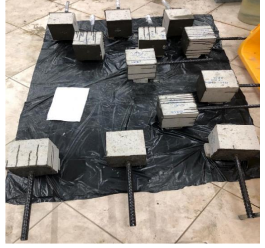
Şekil 4.6 Kalıplara Yerleştirilmiş ve Epoksi Koruması Yapılmış Numunelerden Görünüm
