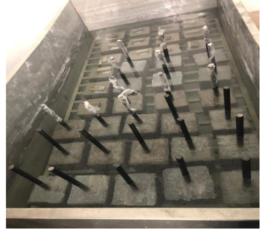
Şekil 4.8 Numunelerin Kür Havuzundaki Saklanma Koşulları
