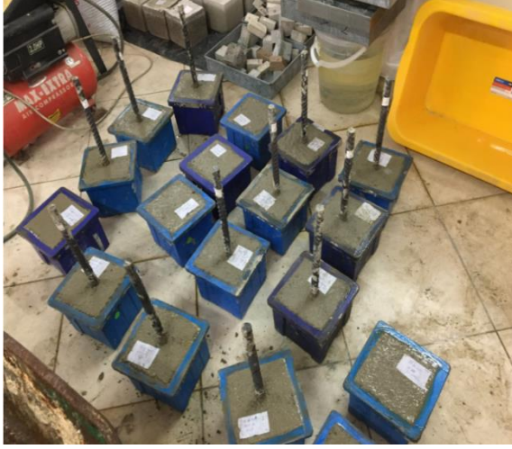
Şekil 4.6 Kalıplara Yerleştirilmiş ve Epoksi Koruması Yapılmış Numunelerden Görünüm
