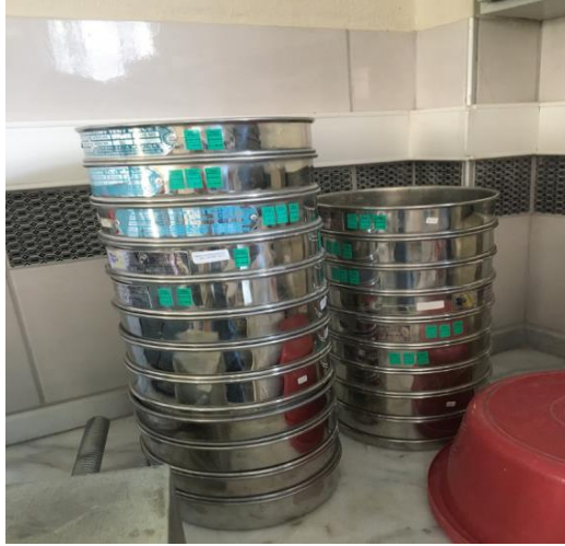
Şekil 4.3 Elek Analizinde Kullanılan Elek Takımı ve Sınıflandırılmış Agregalar
