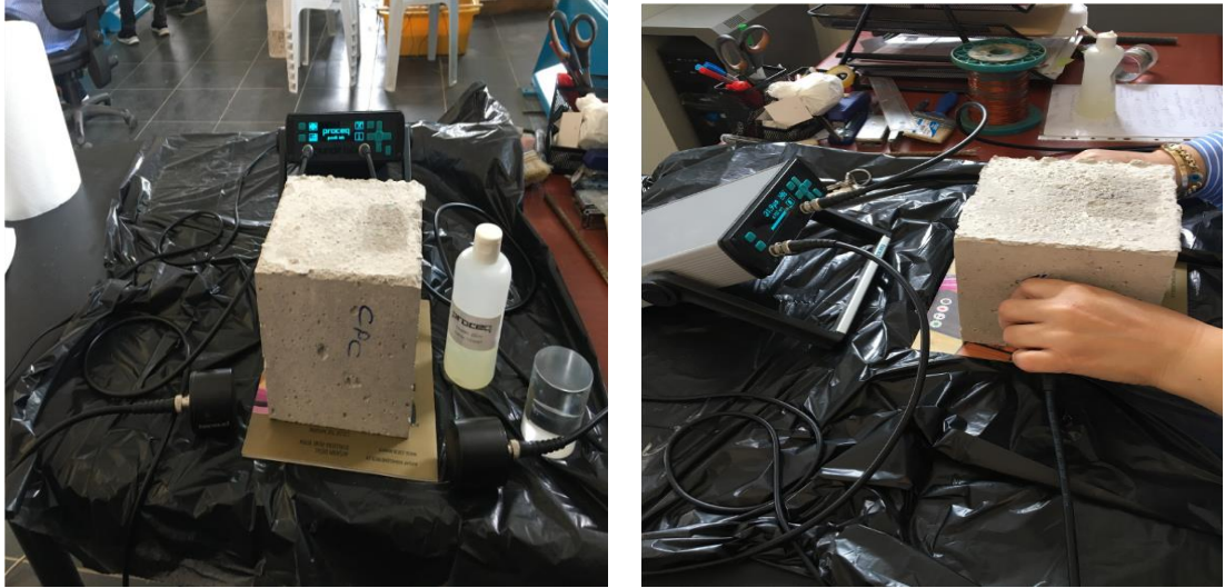
řekil 4.18 lmlere Hazır Hale Getirilmiş Numune ve UPV lm Deney Anından Grnm
