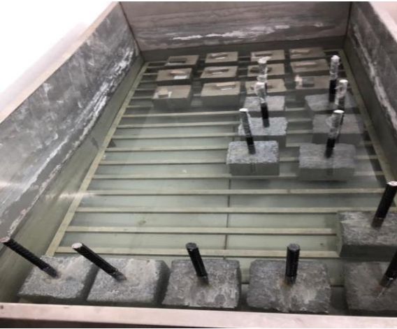
Şekil 4.8 Numunelerin Kür Havuzundaki Saklanma Koşulları
