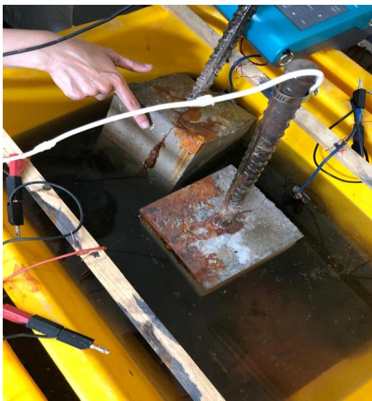
Şekil 4.16 Yarı Hücreli Potansiyel Ölçüm Deneyi
