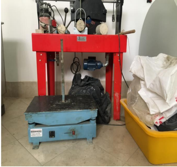
Şekil 4.7 Numunelerin Sıkıştırılmasında Kullanılan Sarsma Tablası
